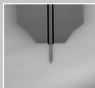
Arrow™ TL1 Кантилевер без иглы, одна балка кантилевера на кремниевом чипе
