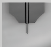
Arrow™ TL1 ティップレスカンチレバー サポートチップにカンチレバー が1本形成されている
