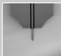
Arrow™ TL1 Cantilever sin punta, cantilever único sobre un chip portador de silicio monocristalino
